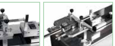
Controllo calibri di profondità. Control of depth calipers.
