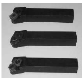
Рис. 7.27 – Универсально-сборные резцы для обработки точением: а, б, в – резцы с поворотной рабочей частью (Патенты Украины: 12364А и 51167А), г – резцы со сменными вставками (Патенты Украины: 22060А, 51165А, 63498А, 52664, 54442)
