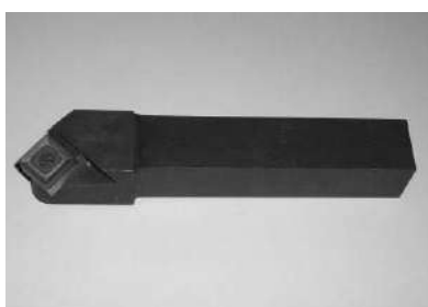
Рис. 7.27 – Универсально-сборные резцы для обработки точением: а, б, в – резцы с поворотной рабочей частью (Патенты Украины: 12364А и 51167А), г – резцы со сменными вставками (Патенты Украины: 22060А, 51165А, 63498А, 52664, 54442)
