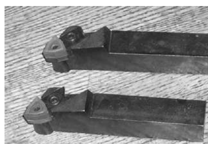
Рис. 7.27 – Универсально-сборные резцы для обработки точением: а, б, в – резцы с поворотной рабочей частью (Патенты Украины: 12364А и 51167А), г – резцы со сменными вставками (Патенты Украины: 22060А, 51165А, 63498А, 52664, 54442)
