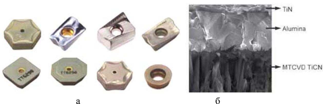
Рис. 6.34. Фрезерные пластины для обработки чугуна (а) и микроструктура сплава и покрытия (б)
