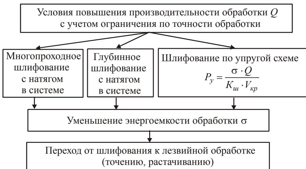
Рис. 2.16. Структурная схема условий повышения производительности обработки
