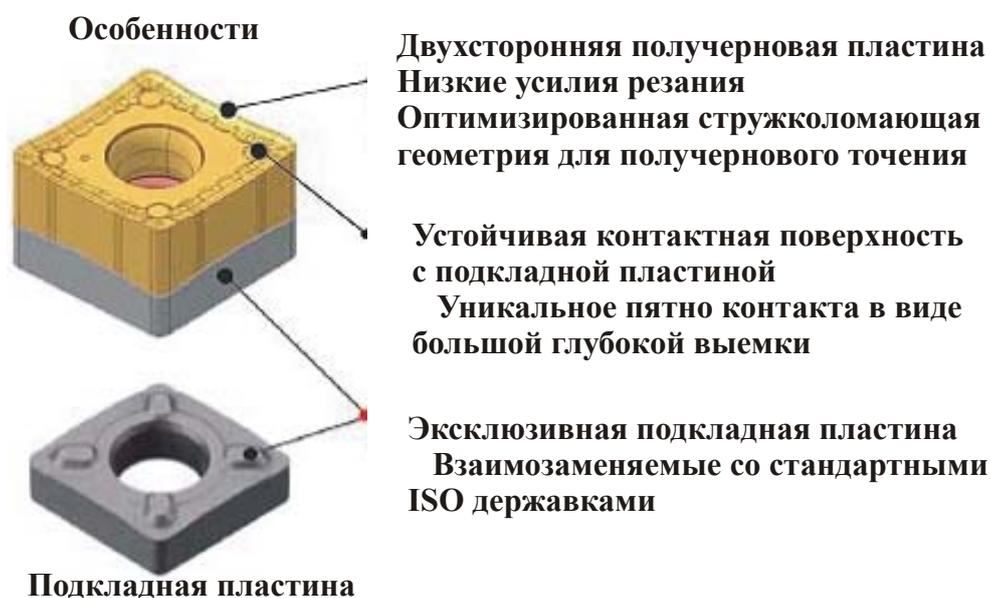
Рис. 6.24. Особенности пластин со стружколомающей геометрией НВ
