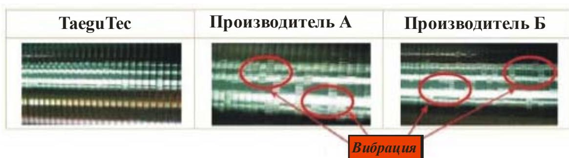
Рис. 6.29. Обработанная поверхность. Следы от вибрации
