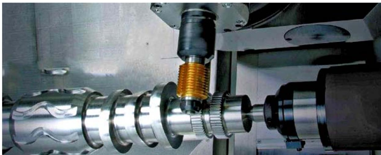
Рис. 6.1. Обработка сложнопрофильной детали на станке DOOSAN
