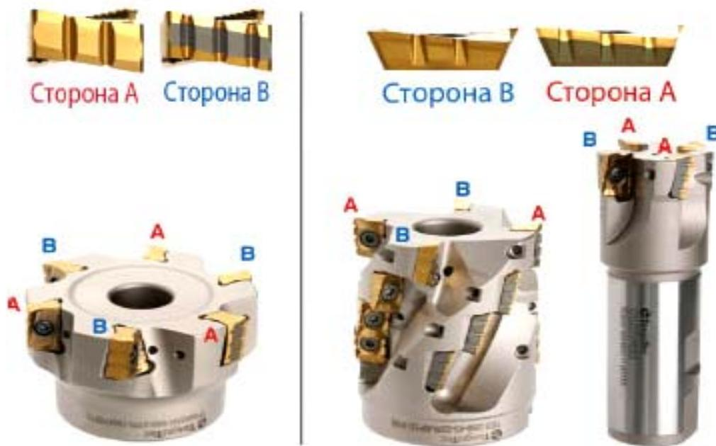
Рис. 6.59. Схема чередования пластин
