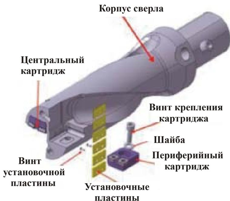
Рис. 6.93. Сверло серии T-Drill с картриджами
