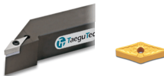
Рис. 7.4. Сборный токарный резец с углом в плане 93° и со сменной многогранной пластиной TT8115
