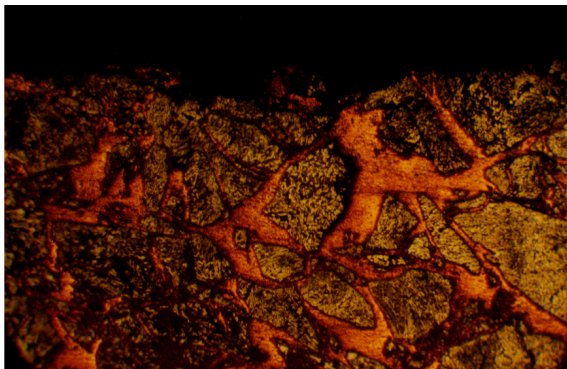
Рис. 2.15. Микроструктура композиции "твердый сплав "Релит" – медь"
