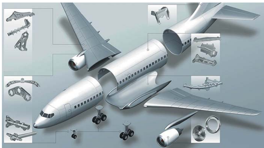
Рис. 6.2. Детали и узлы самолета, которые подвергаются механической обработке
