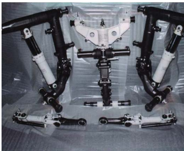
Рис. 6.13. Шасси, изготовленное из титана BT22
