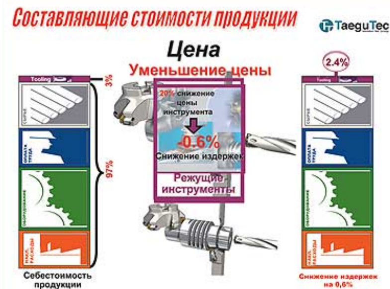
Рис. 7.59. Влияние снижения стоимости инструмента как расходного материала на составляющие себестоимости продукции
